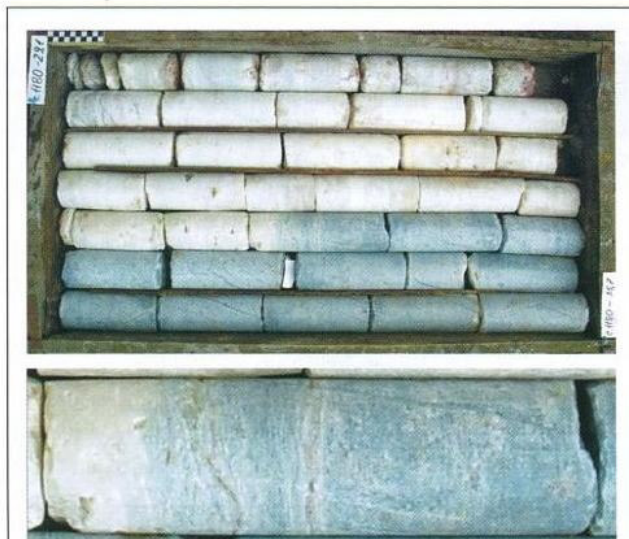
Рис. 1. Образцы керна из зоны гидратации сакмарских ангидритов Окско-Волжского междуречья (фото М.О. Нещеткина). Длина масштабной линейки — 10 см
