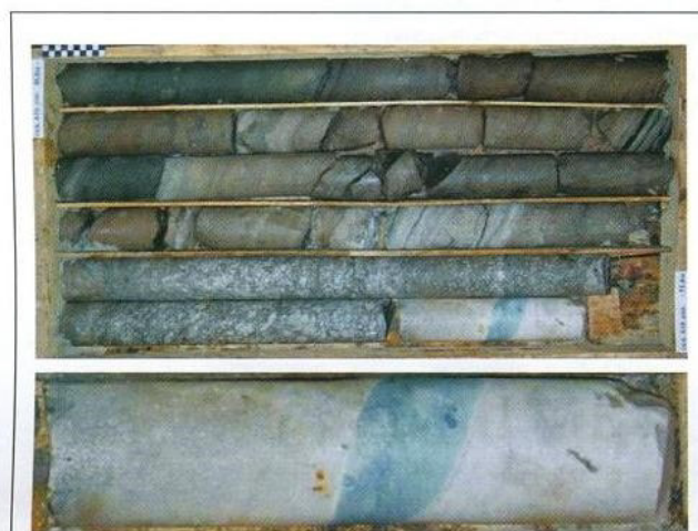
Рис. 2. Образцы керна из зоны гидратации кунгурских ангидритов Пермского края (фото М.О. Нещеткина). Длина масштабной линейки — 10 см
